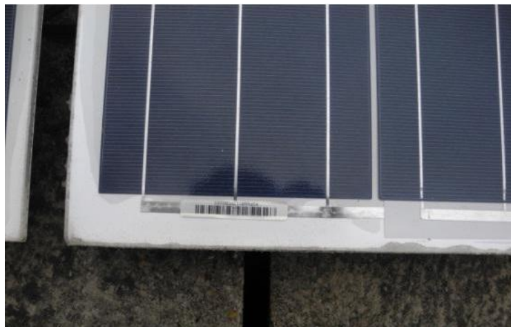
图 2-7 光伏组件进水
