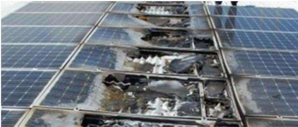
图 1-9 直流电弧引起的事故
